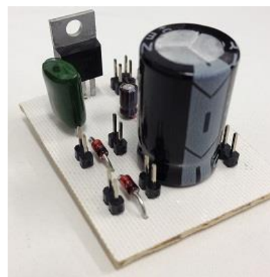
Figura 10 – PCI de condicionamento de sinais
