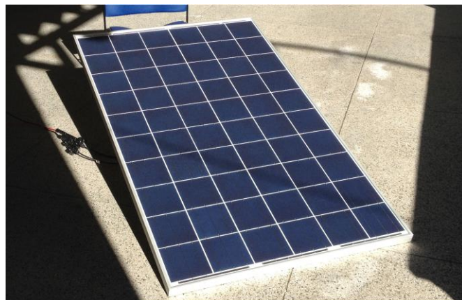
Figura 14 – Painel Fotovoltaico ligado ao controlador de carga durante o teste
