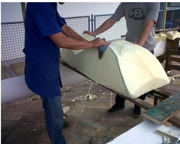
Figura 08: Fase de finalização do molde para fabricação do assento.
