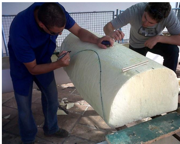
Figura 06: Processo de transferência do perfil do assento para o molde.
