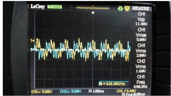
Figura 2 - Formas de onda das correntes impostas pelo inversor à 5800 rpm.
