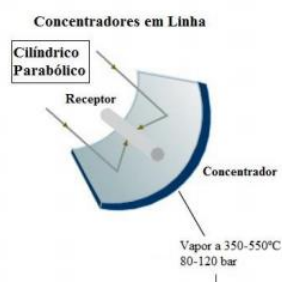
Figura 1 – Funcionamento de cilindro – parabólico mediante incidência de radiação Solar.
